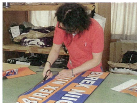
型紙に合わせて編み地を切っていきます
