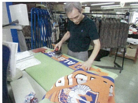
検針機(金属探知機)を通した後、仕上げのアイロンをかけます
