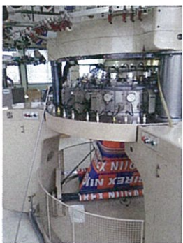
キヤドで作った柄をコンピューター編機に入れて編み込みます
