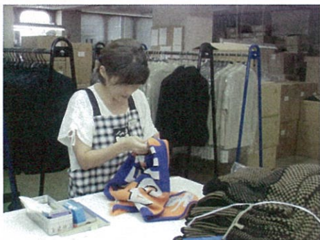
縫い上がった製品のいらない糸を切って仕上げ作業に入ります
